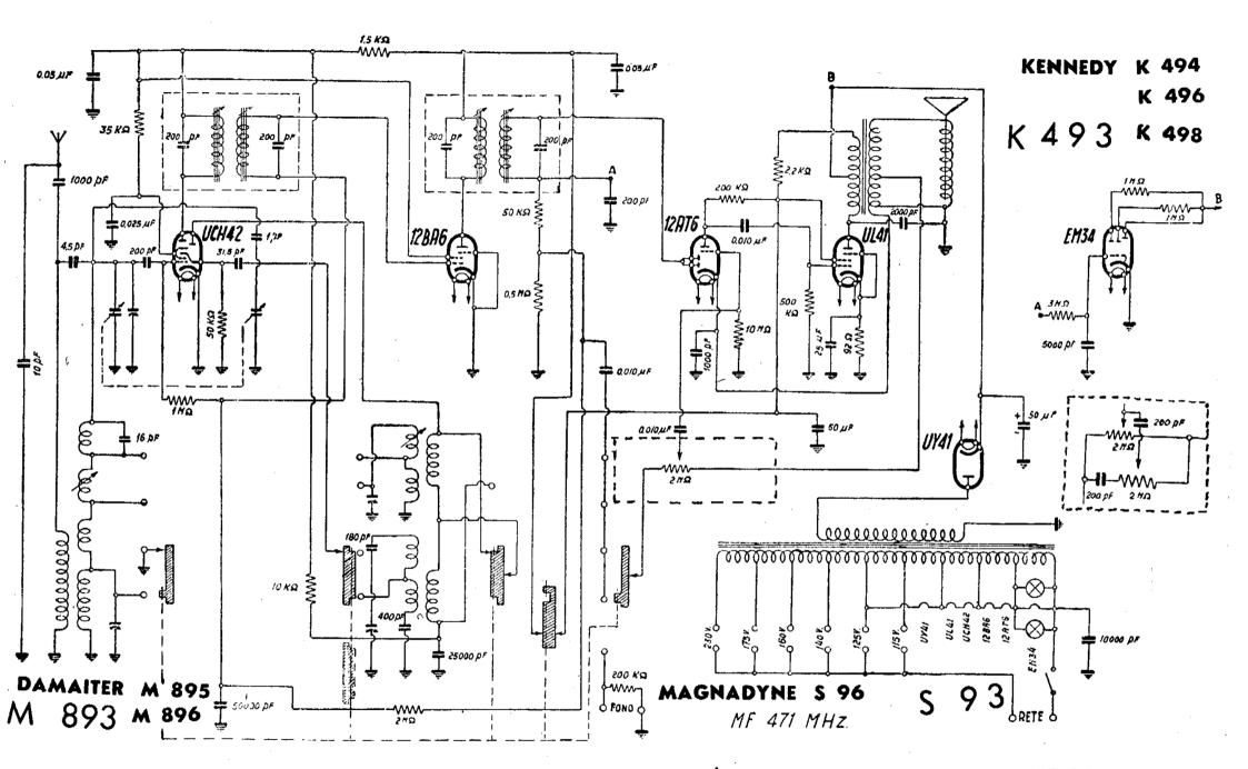
MAGNADYNE RADIO - Modd. MAGNADYNE S 93, S 96, S 97; DAMAÍTER M 802, M 893, M 895, M 896; KENNEDY K 402, K 493, K 494, K 496 e K 498. Onde medie suddivise e due gamme di onde corte. Media frequenza 471 kc/s. Controllo di volume con compensazione dei toni bassi a reazione inversa. I modd. Magnadyne S 97, Damaiter M 802 e Kennedy K 402, differiscono dagli altri menzionati, per l'aggiunta del controllo di tono e nella serie delle valvole.
